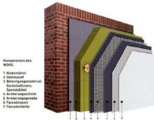
Abb. 11: Verklebtes und verdübeltes WDV-System auf Ziegel-Mauer (Renovationprofis 2011)
